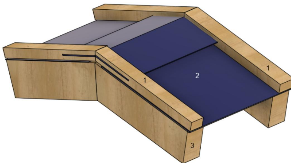
Abb. 55 Firstausführung Verklebte Unterspannung Querschnitt (Klasse 4)
