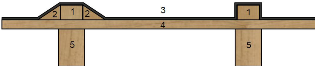
Abb. 3 Wasserdichtes Unterdach bei ungedämmten Dächern (Klasse 1)
