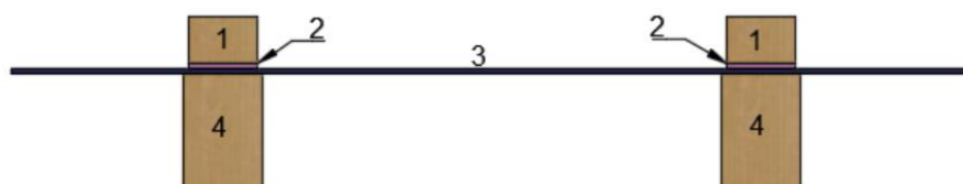
Abb. 50 Verklebte Unterspannung mit Nageldichtband/-masse (Klasse 3)
