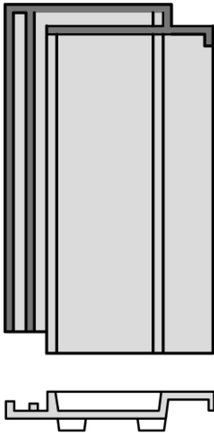
Abb. 23 Höhenüberdeckung: Der Ziegelfuß überdeckt den Kopffalz/die Kopfrinne des darunter liegenden Ziegels
