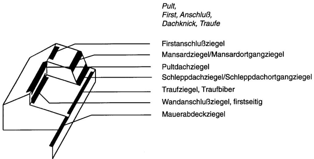
Abb. 71 Formziegel: Pult, First, Anschluss, Dachknick, Traufe, Eckziegel
