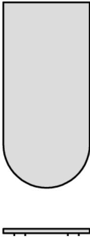
Abb. 33 Höhenüberdeckung: Der Ziegelfuß überdeckt neigungsabhängig den darunter liegenden Ziegel - Biberschwanzziegel-Doppeldeckung
