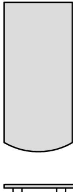
Abb. 67 Glatter Ziegelkopf und-fuß sowie glatte seitliche Überdeckungsgebiete – Biberschwanzziegel / Segmentschnitt
