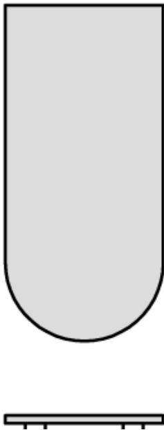
Abb. 66 Glatter Ziegelkopf und-fuß sowie glatte seitliche Überdeckungsgebiete – Biberschwanzziegel / Rundschnitt
