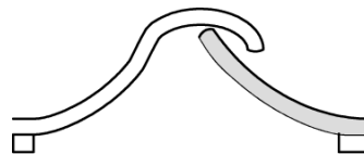
Abb. 59 Seitenüberdeckung: Die Krempe überdeckt die seitliche Aufkantung des Nachbarziegels.
