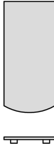
Abb. 34 Höhenüberdeckung: Der Ziegelfuß überdeckt neigungsabhängig den darunter liegenden Ziegel - Biberschwanzziegel-Kronendeckung
