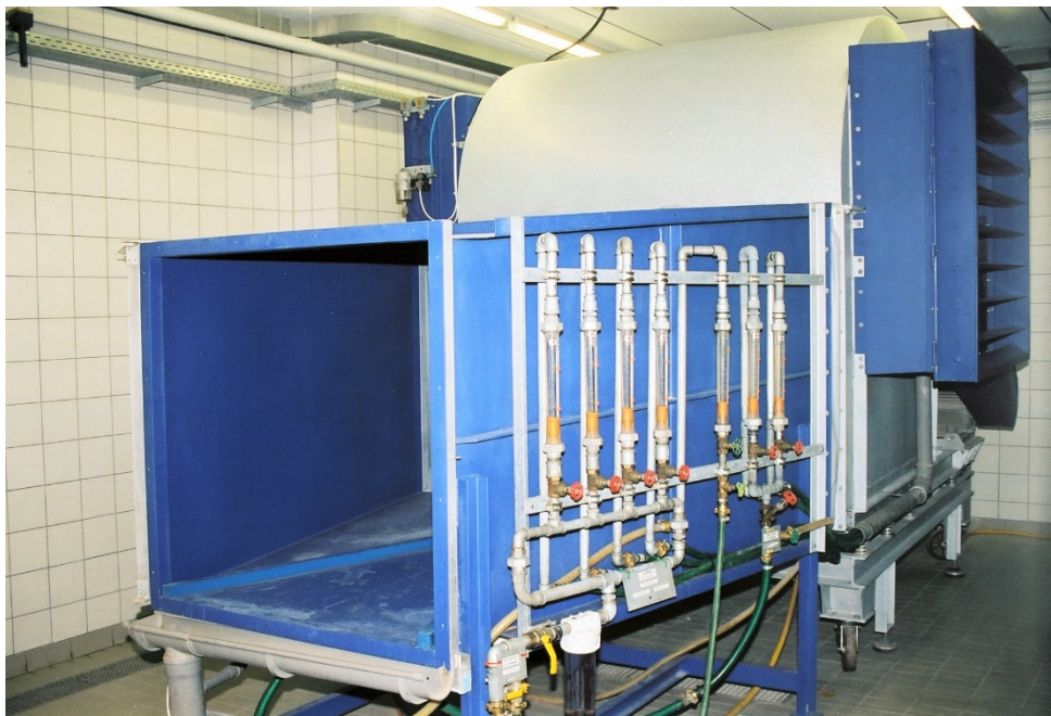
Bild 1: Schlagregenprüfstand der TU Berlin 3
