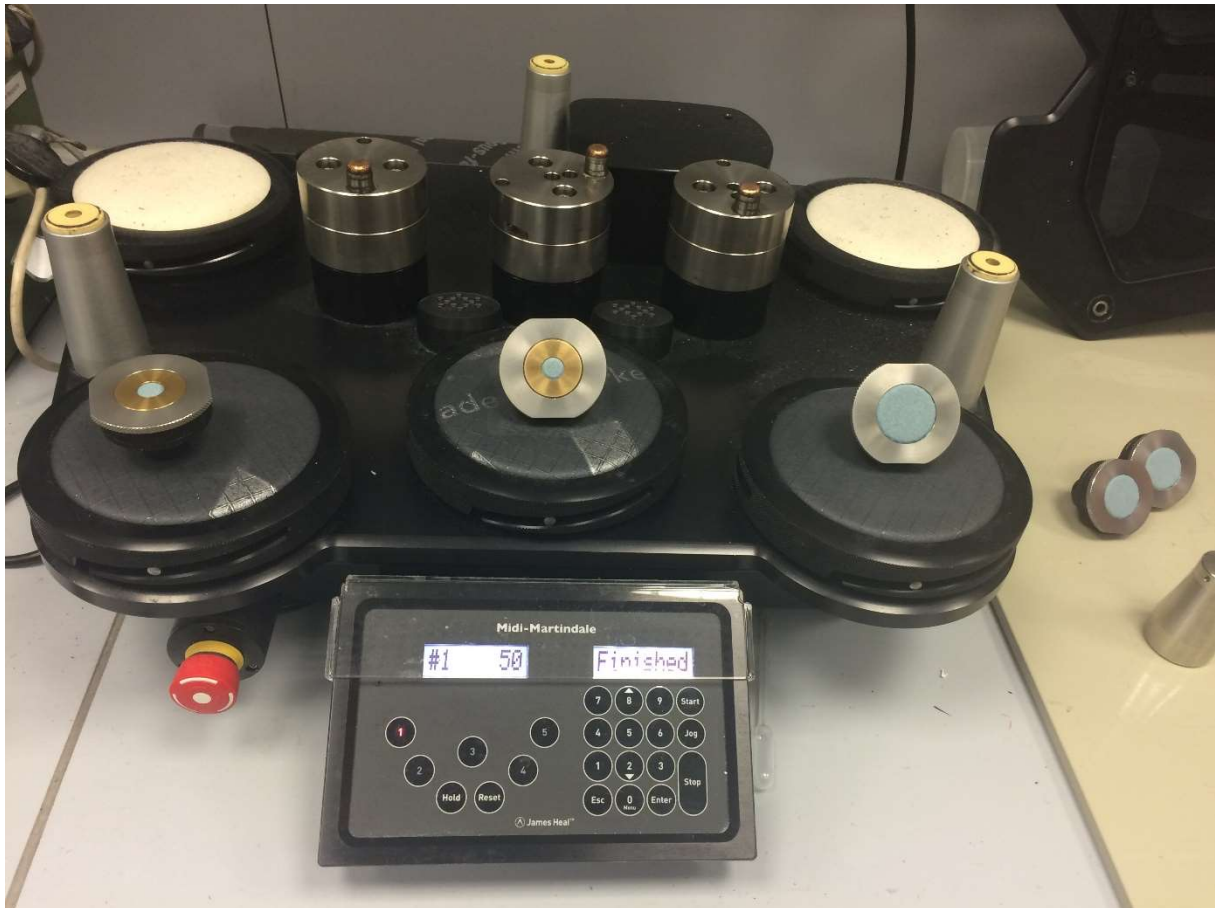
Abbildung 2: Martindale-Verfahren mit reduzierter Reibfläche des Arbeitseinsatzes (Mitte und links) und mit "normalen" Arbeitseinsatz (rechts); Die jeweilige Reibfläche ist erkennbar an dem hellblauen Schmirgelpapier
