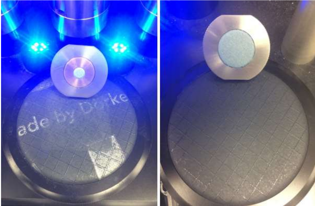
Abbildung 3: Oberflächlicher Abrieb bei reduzierter Reibfläche und 50 Touren (links) sowie bei "normalen" Arbeitseinsatz und 100 Touren (rechts); Während in der linken Abbildung ein deutlicher Materialabtrag erkennbar ist, wurde die Bahnenoberfläche in der rechten Abbildung nur aufgeraut und erscheint deswegen im Bereich mit Kontakt zum Arbeitseinsatz „matter“ als im Randbereich.
